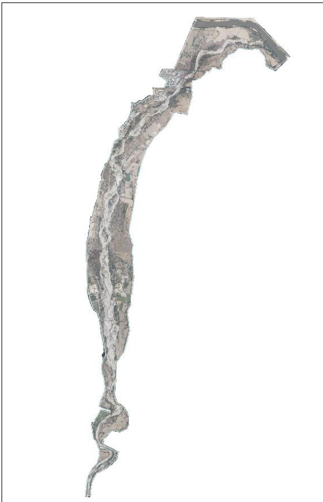
Figura 7 – estensione del dominio di calcolo del modello bidimensionale del fiume Trebbia, da Rivergaro al Po
